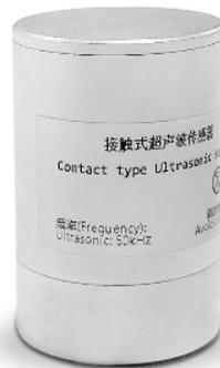
接触式超声波传感器接收方式跟内置的开放型超声波传感器不一样，传感器接触面需要良好的跟被测设备接触，必要的时候需要涂抹耦合剂，以保证接触面到传感器之间的声阻尽可能最小。
