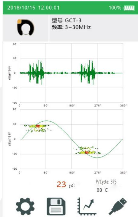
此界面上方为时域信号波形区域，实时显示采集到的信号，下方为 PRPD 相位图谱，随着时间的变化，PRPD 图谱会不断重绘放电信号与相位之间的关系，PRPD 图谱的意义在于可以根据相位与放电幅值之间的关系分析出当前设备的放电特征是否具有 50Hz 与 100Hz 相关性、放电信号在相位区间的重复性等。
