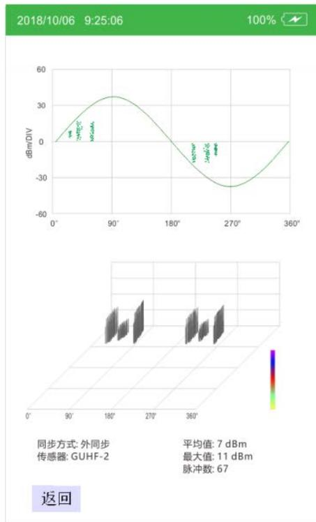
绝缘件内部气隙放电主要是固体绝缘内部开裂、气隙等缺陷所致，此类放电放电次数少，周期重复性低。放电幅值也较分散，但放电相位较稳定，无明显极性效应。
