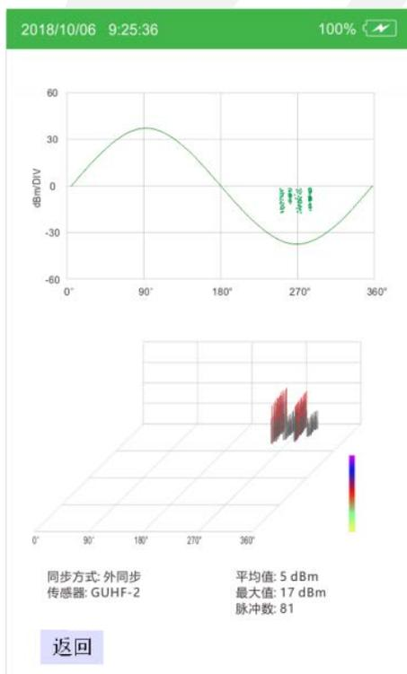
金属尖端放电是处于高电位或低电位的金属毛刺或尖端，由于电场集中而产生的 SF6 电晕放电。此类放电次数较多，放电幅值分散性小，时间间隔均匀。放电初期通常仅在工频相位的负半周出现。
