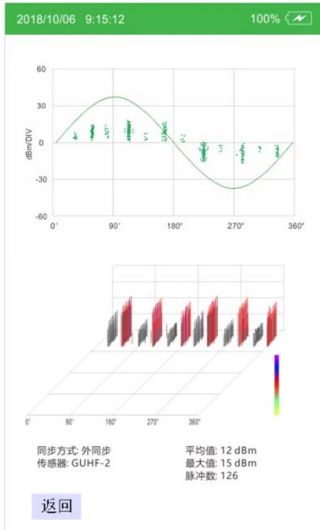
自由金属颗粒放电为金属颗粒和金属颗粒之间的局部放电以及金属颗粒和金属部件间的局部放电。此类放电幅值分布较广，放电时间间隔不稳定，其极性效应不明显，在整个工频周期相位均有放电信号分布。
