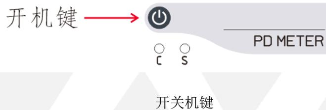
本产品通过触摸式开关键实现【开机】或【关机】，只需要在【电源标识】上轻触 3 秒，听到“滴”一声松开手指即可开机，开机后状态指示灯会显示当前主机的工作状态，如果连接了电源适配器，并且电池在充电状态时指示灯 C 将点亮，直到电池充电完毕。
