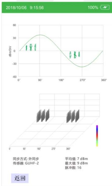
悬浮电位体放电为松动金属部件产生的局部放电，此类放电脉冲幅值稳定，且相邻放电时间间隔基本一致。当悬浮金属体不对称时，正负半波检测信号有极性差异。
