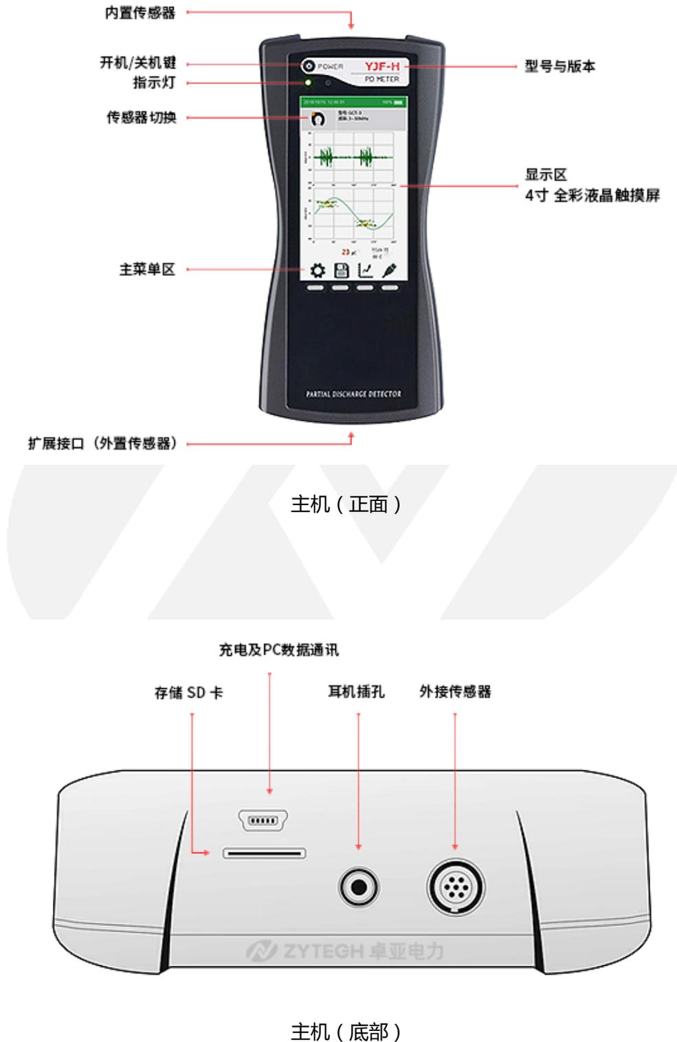
主机的前端内置一个非接触式超声波传感器和一个内置式 TEV 地电波传感器，不外接传感器的情况下可以实现高低压开关柜局部放电的检测，如需对环网柜、变压器、GIS、架空线路、电缆终端、电缆分支箱等设备局部放电检测，只需要通过主机底端的传感器扩展口外接相应的专用传感器即可，主机可根据传感器的不同自动切换测量模式。外接的传感器可以参考产品配置清单中【表一】的选配部分。
